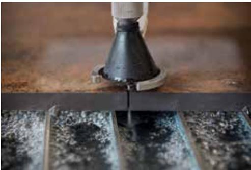
Unabhängig vom Modell bestehen alle konstruktiven Bauteile und Schrauben aus rostfreiem Edelstahl oder Aluminium. Charakteristisch sind der flache Unterboden sowie die glatten Seitenwände mit verdeckten Linearführungen ohne Faltenbälge und ein in den Achsen mitgeführtes Hochdruckrohr.
